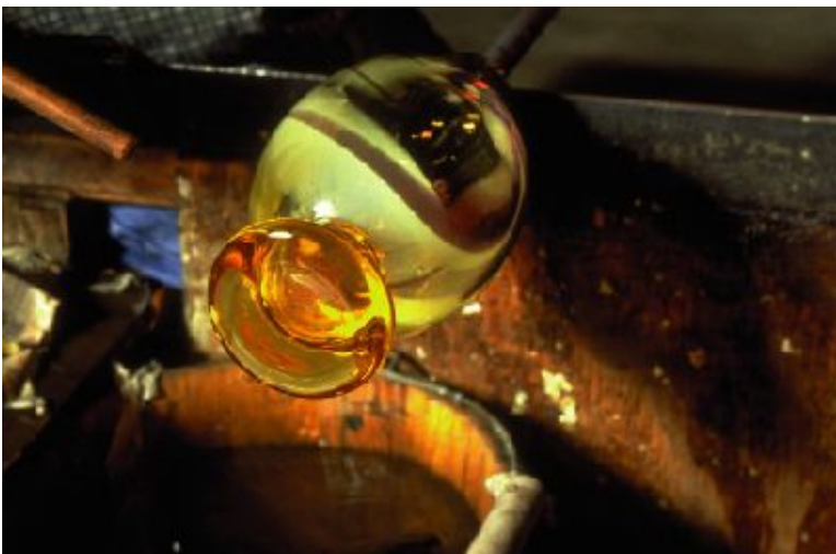
Figuur 1-32: De gevormde voet wordt hol gemaakt. De holte heet de 'ziel'. Door middel van koude lucht ontstaat een stollingsproces in de gevormde voet.
