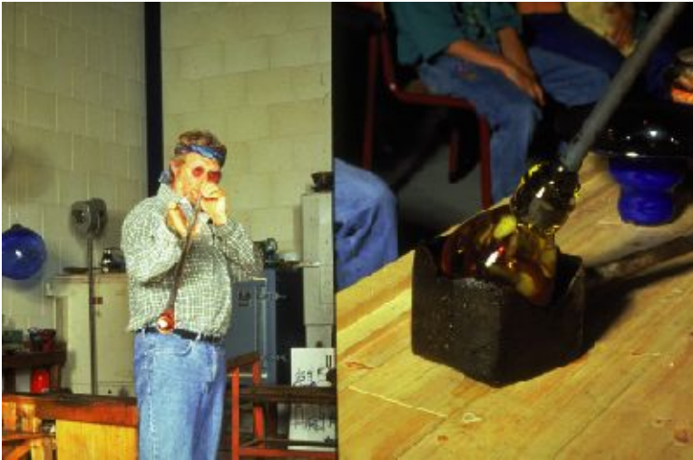
Figuur 1-26: Er is een nieuwe glaslager aangebracht. De kleur zit nu in het glas. Met een natte krant wordt de glasmassa verder gevormd.
