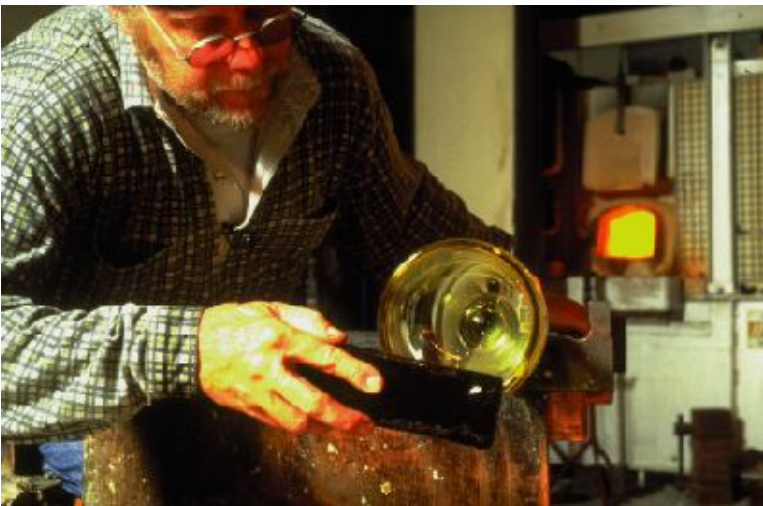
Figuur 1-36: De hals wordt met perenhout vlakgemaakt.
