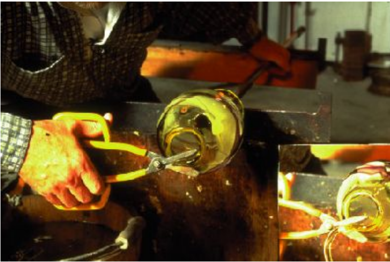
Figuur 1-36: De hals wordt met perenhout vlakgemaakt.
