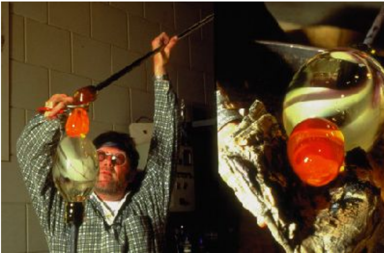
Figuur 1-32: De gevormde voet wordt hol gemaakt. De holte heet de 'ziel'. Door middel van koude lucht ontstaat een stollingsproces in de gevormde voet.
