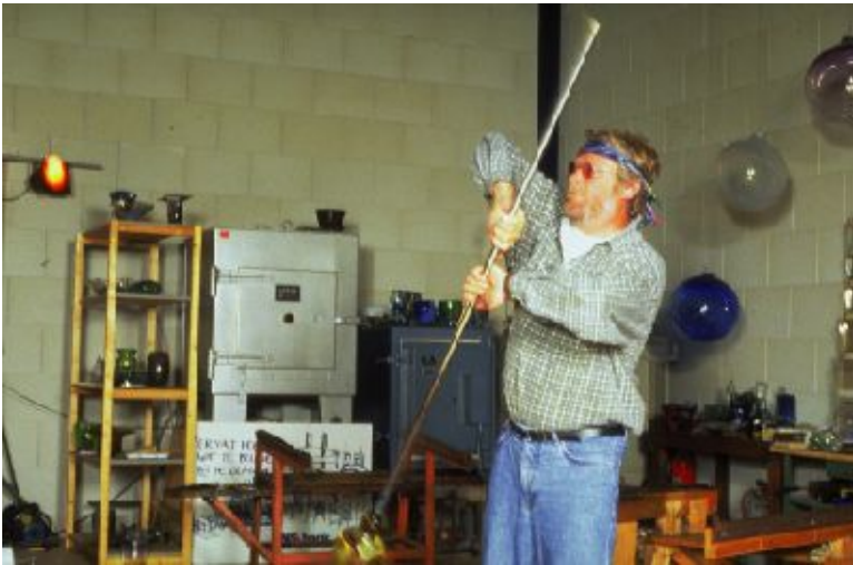
Figuur 1-30: Met een blaaspijp wordt een nieuwe 'post' glas uit de oven gehaald om de voet van de vaas te maken.
