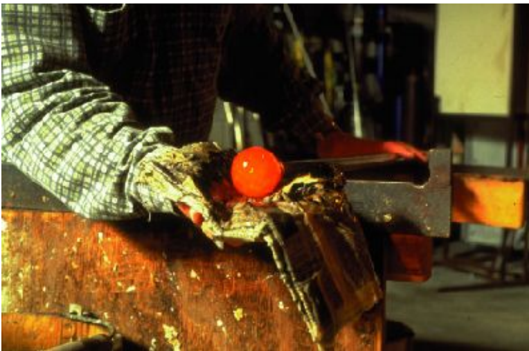
Figuur 1-26: Er is een nieuwe glaslager aangebracht. De kleur zit nu in het glas. Met een natte krant wordt de glasmassa verder gevormd.
