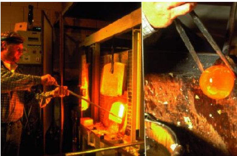
Figuur 1-30: Met een blaaspijp wordt een nieuwe 'post' glas uit de oven gehaald om de voet van de vaas te maken.
